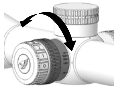
Position de l'image 2 Compensation de la parallaxe
