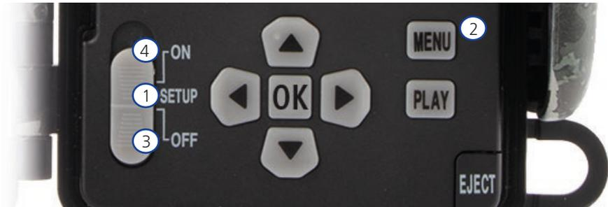
1. **SETUP:** Schalter auf die Position „SETUP“ stellen: Der Bildschirm schaltet sich ein und für etwa 2 Sekunden ist der Startbildschirm zu sehen. Danach wechselt die Kamera in den Vorschaumodus und zeigt im Display den Ausschnitt, der auch bei den Aufnahmen zu sehen wäre.
