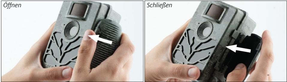
**Öffnen:** Lösen Sie die Verschlussklammer auf der rechten Seite der Kamera. Fassen Sie mit zwei Fingern hinten in den Verschluss und ziehen Sie diesen von der Kamera weg, bis der Verschluss aufklappt.
