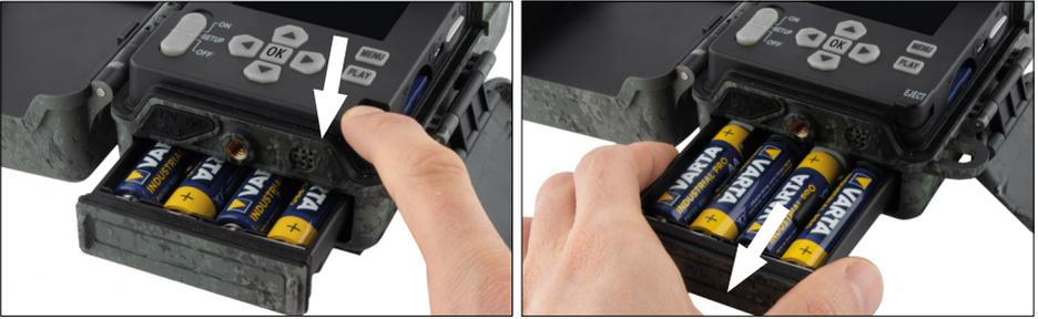
Achten Sie beim Einlegen der acht vollgeladenen Batterien oder Akkus bitte unbedingt auf die richtige Polarität; diese ist im Batteriefach markiert. Schieben Sie das Batteriefach wieder komplett in die Kamera bis dieses einrastet.
