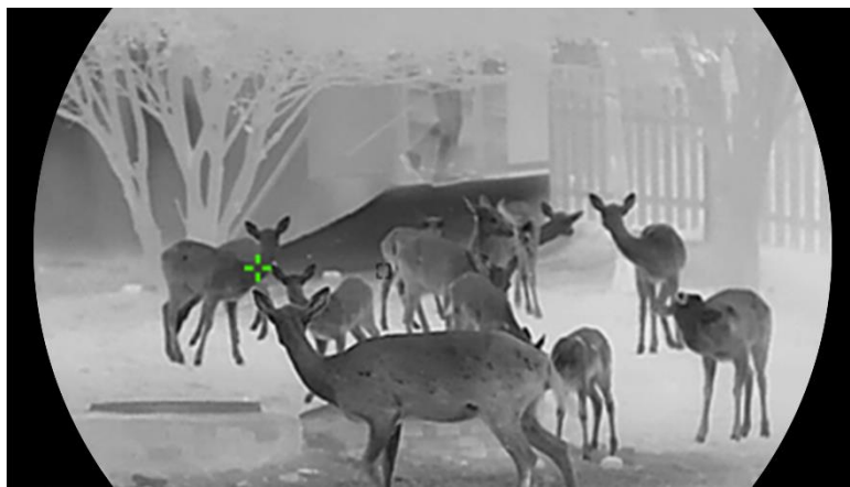
Abbildung 6-1 Stelle mit höchster Temperatur verfolgen
