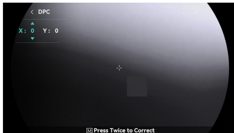
Abbildung 3-5 Defekte Pixel korrigieren
